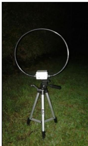
Pero también se puede realizar una bobina con un condensador variable, en formato loop.
